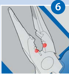
6 Снятие изоляции диаметром от 3,5 до 4,0 мм.
