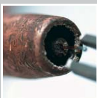
Вытягивание проволоки из сопла.
