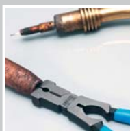
Удаление сварочных брызг с кончика сопла.
